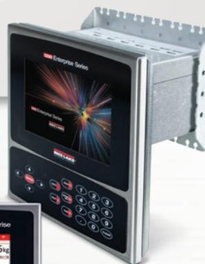
La versione da pannello di facile montaggio richiede solo 5 fori per l'installazione.
