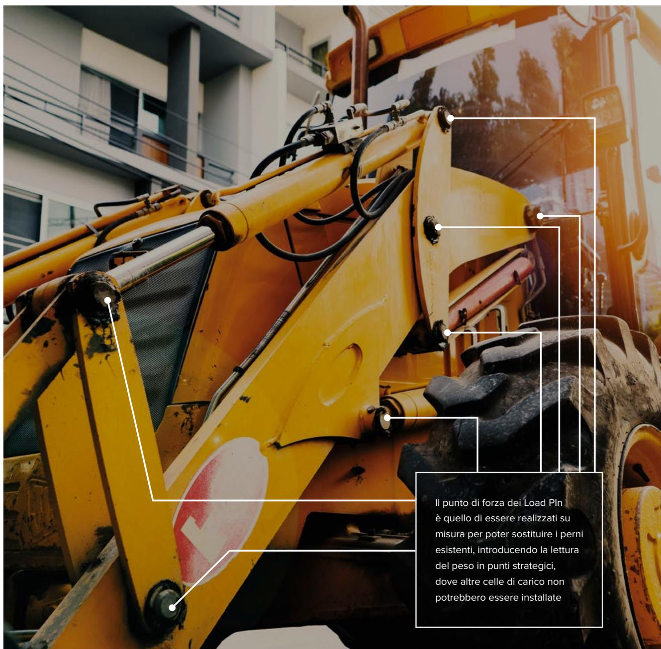
Il punto di forza dei Load Pin è quello di essere realizzati su misura per poter sostituire i perni esistenti, introducendo la lettura del peso in punti strategici, dove altre celle di carico non potrebbero essere installate
