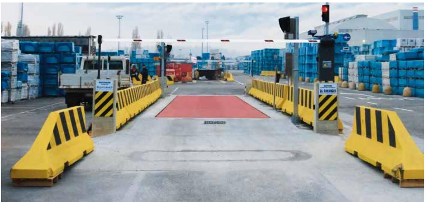
pesare con maggiore precisione carichi contenuti, mantenendo inalterata la grande capacità di carico. Le pesate eseguite con la pesa WBS sono OMOLOGATE per utilizzo in rapporto con terzi, secondo la normativa EN45501.
