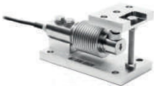
Kit di montaggio con sistema antiribaltamento singolo e compensazione delle forze laterali per celle di carico a Flessione serie FXC e FXD fino a 500 kg. Dotati di snodo a sfera per la pesatura ad alta precisione.
